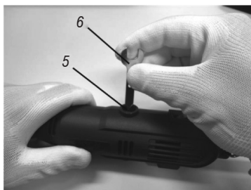
Fig. 6 – Sustrucción de cepillo carbón
