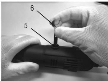
Fig. 6 – Substituição da escova de carvão
