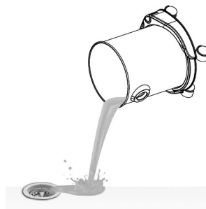
Fig. 12 – Removiendo el líquido del reservatorio
